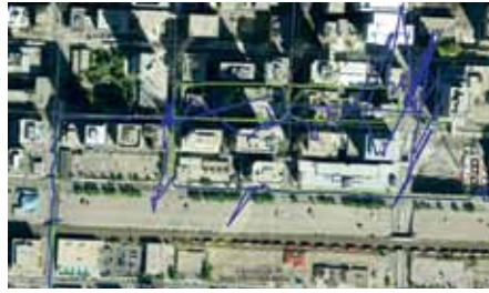
Bild 5. Lösning med integrerad MEMS/GPS/OBDII (MEMS + GPS + OBDII grönt, endast GPS blått).
