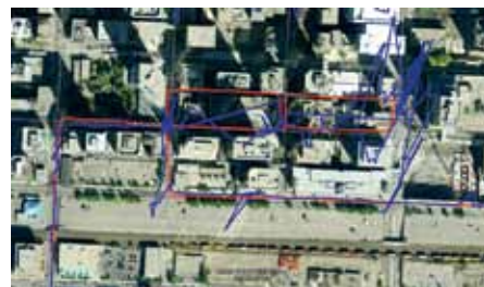
Bild 3. Lösning med integrerad FOG/GPS (FOG + GPS rött, endast GPS blått).
