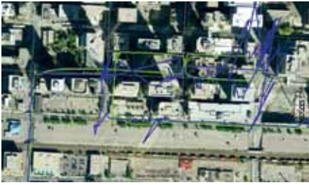
Bild 4. Lösning med integrerad MEMS/GPS (MEMS + GPS grönt, endast GPS blått).
