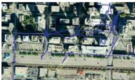
Bild 2. Resultat för enbart GPS med reflekterade signaler.
